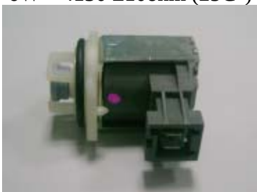
Electrovanne régénération 6W – 4130 ±10ohm (25C°)
